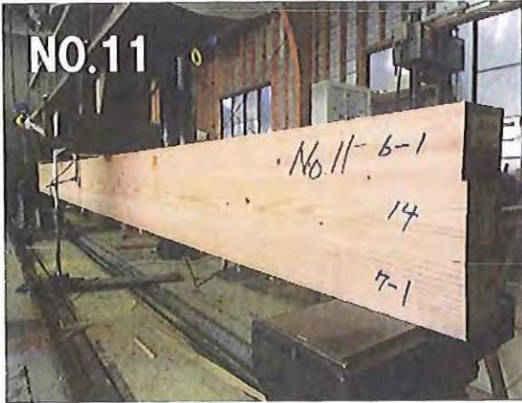
【付録：新 A 型接着重ね梁の強度試験の様子】
