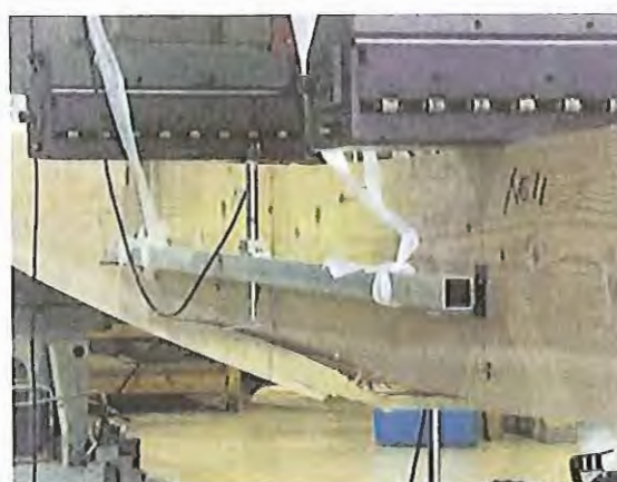
写真 4 モーメント一定区間のたわみの測定
