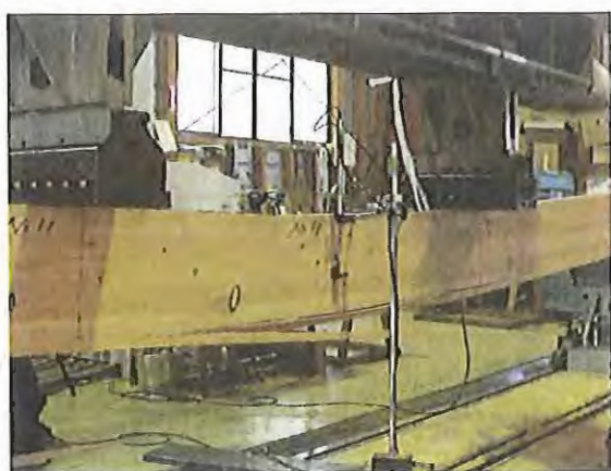
写真 3 全スパンのたわみの測定
