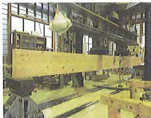
写真 2 曲げ試験の様子
