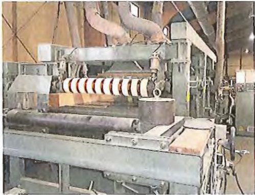
製材ラミナの接着前の寸法修整
